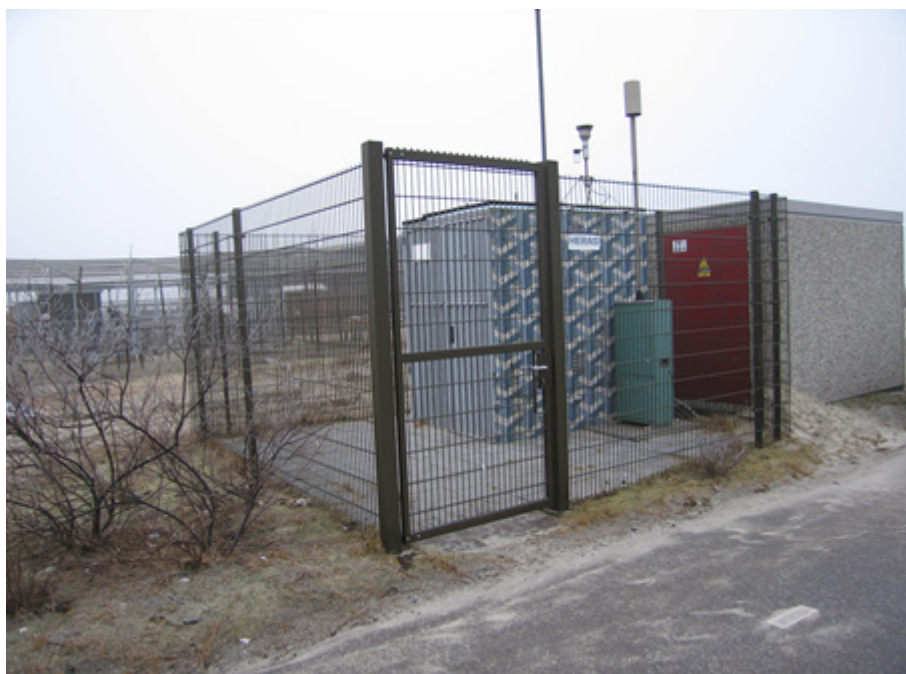
Afbeelding 5.35 Meetstation voor luchtverontreiniging van DCMR Milieudienst Rijnmond aan de Markweg op Europoort. Op de voorgrond met het groene uiterlijk een meetapparaat voor de fijner fractie van fijn stof (PM 2,5 ) inclusief aanzuigpijp. Daarachter is nog de aanzuigleiding voor de fijnstofmonitor zichtbaar. Het meetapparaat zelf bevindt zich in de meetbehuizing. Foto © DCMR Milieudienst Rijnmond.
