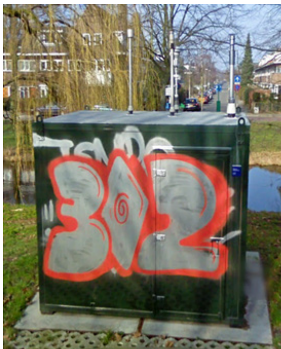
Afbeelding 5.38 Stedelijke meetstations van het Landelijk Meetnet Luchtkwaliteit van het RIVM in Utrecht (links) en van het meetnet van de GGD in Amsterdam. De 'pijpen' op de behuizing zijn de aanzuigingen voor de diverse meetsystemen. Foto's © Centrum voor Milieukwaliteit, RIVM (links) en GGD Amsterdam (rechts).
