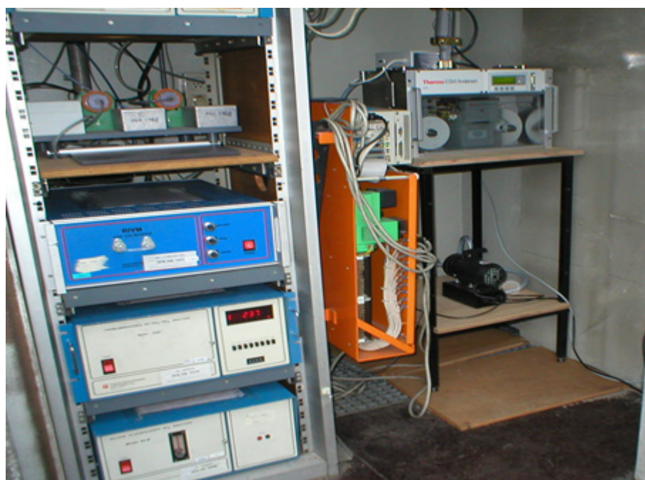
Afbeelding 5.33 Interieur van een meetstation voor luchtkwaliteit in het Landelijk Meetnet Luchtkwaliteit. Rechtsboven het meetapparaat voor fijn stof ( PM_{10} ) met randapparatuur. Links staan een aantal meetsystemen voor gasvormige luchtverontreiniging. Foto © D. van Straalen.
